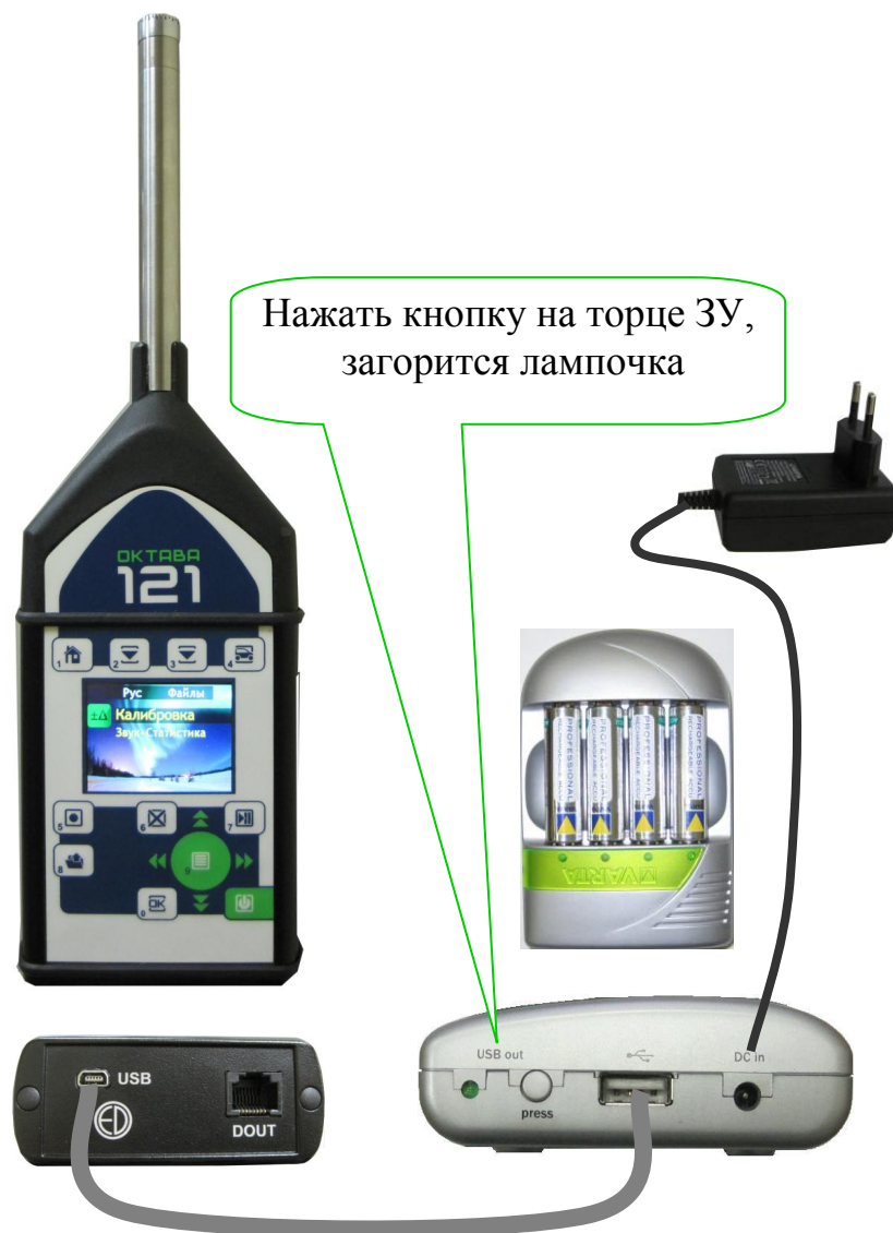
Схема 3. Подключение прибора к внешнему источнику питания
