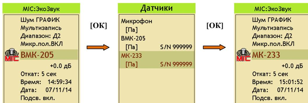
Выберите нужный датчик из списка клавишами [ВНИЗ] и [ВВЕРХ] и нажмите клавишу [ОК]. Выбранный датчик и его калибровочная поправка появятся в меню измерительной программы.
