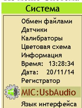
Эта программа превращает прибор в цифровой микрофон, который можно подключать к компьютеру как типовое устройство **USB Audio** и выполнять звукозапись стандартными средствами операционной системы и программами.
