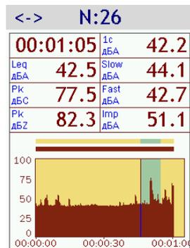
На графике в нижней части показано изменение во времени текущего уровня звука или вибрации. Зона обработки показана вертикальной полосой (на рисунке – полоса светло-зелёного цвета). При открытии файла вся мультizaпись попадает в зону обработки.
