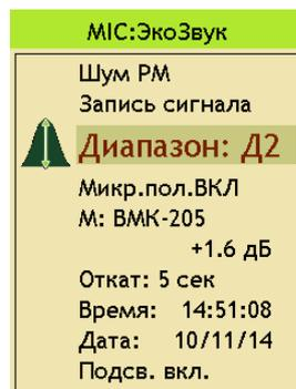
Если в меню измерительной программы выбрать тип сохранения данных **Запись сигнала**, то вы сможете одновременно с измерениями осуществлять запись временных реализаций сигналов. Характеристики записываемых сигналов (частотный диапазон, частота выборки и т.п.) могут быть разными для различных измерительных программ (см. раздел соответствующей измерительной программы).
