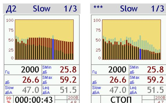
Когда воспроизведение сигнала заканчивается, проценты в левом нижнем углу исчезают, а рядом появляется слово **СТОП**. Если при этом вы проводили обработку сигнала (то есть запустили измерение клавишей **[СТАРТ]**), то на экране останутся результаты измерений.
