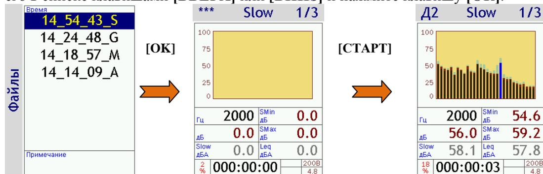
Вы увидите обычное окно измерений, в левом нижнем углу которого будут бежать проценты. Эти проценты означают, какая доля сигнала уже прошла обработку. Прибор может обрабатывать этот сигнал точно так же, как он обрабатывает сигналы, поступающие на его вход с датчиков. Запуск, остановка и сброс измерения осуществляются клавишами **[СТАРТ/СТОП]** и **[СБРОС]**.
