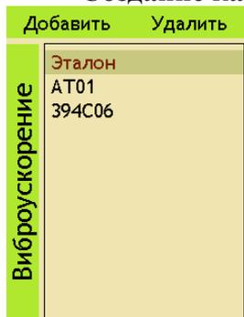
Находясь в меню-списке калибраторов, нажмите левую контекстную клавишу **[Добавить]**. На экране появится карточка, заполненная данными датчика-образца.
