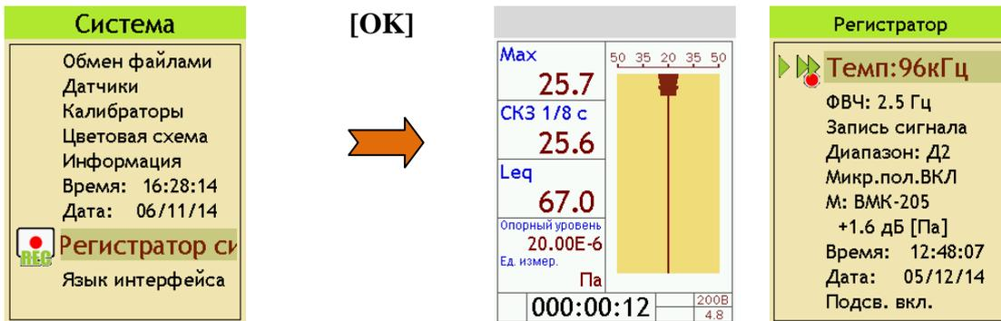
Эта программа позволяет осуществлять запись оцифрованных временных реализаций сигналов от всех трех входных каналов в энергонезависимую память прибора, а также передавать эти реализации по телеметрии на внешние устройства.
