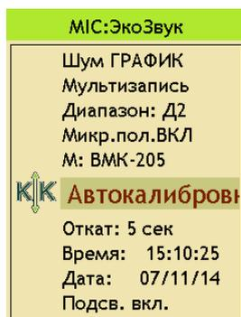
Для активации функции автокалибровки войдите в меню измерительной программы (см.пп.7.3, 7.4), выделите калибровочную поправку нужного канал и нажмите левую контекстную клавишу над экраном. Значения калибровочных поправок каждого датчика заменяются **словом «Автокалибровка»**.
