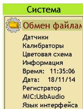
Для того, чтобы открыть доступ к файлам прибора через USB порт, выделите в меню **«Система»** пункт **«Обмен файлами»** и нажмите клавишу **[ОК]**. Прибор превращается в обычную флешку и начинает восприниматься внешними устройствами как съемный диск. На экране появится информационное сообщение
