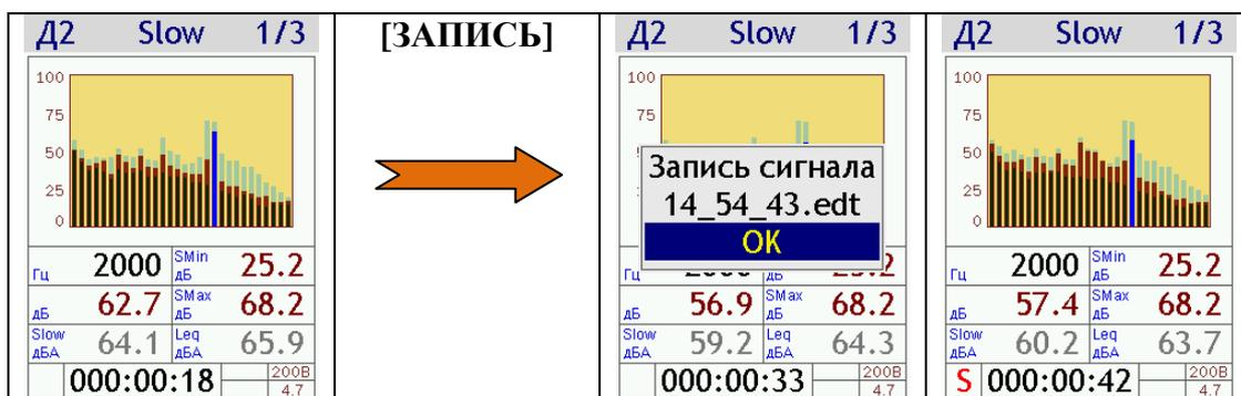
По истечении заданной продолжительности файл записи сигнала закрывается, знак **S** исчезает и окно измерений возвращается к обычному виду.
