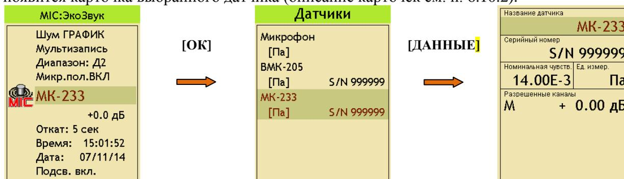
**Примечание:** при открытии карточки датчика из меню измерительной программы функции редактирования отключены. Вы можете только видеть калибровочные данные, но не изменять.
