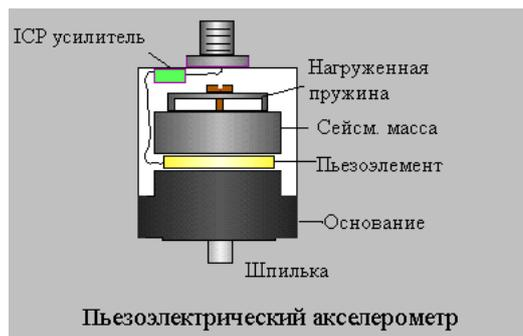
Типовая схема подключения вибродатчиков к прибору рассчитана на применение пьезоакселерометров со встроенной электроникой типа IEPЕ (ICP). Эти датчики не имеют многих недостатков, свойственных классическим пьезоакселерометрам.
