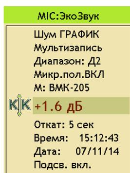
Убедившись в стабильности показаний на частоте калибратора, нажмите клавишу [ЗАПИСЬ] для запоминания калибровочной поправки. Вы вернетесь в меню измерительной программы, а новая калибровочная поправка запишется в карточку датчика и будет отображаться в соответствующем поле меню (с точностью до 0,1 дБ).
