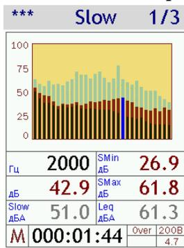
При вызове файла автозамера мы попадаем на самый последний шаг записи. В левом нижнем углу экрана появляется символ **M**, который означает, что на экране представлены данные из памяти прибора.
